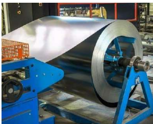
Ilustración 7 Sistema de enrollado de acero
